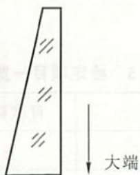
图 2 楔形镜大端方向剖面示意图
